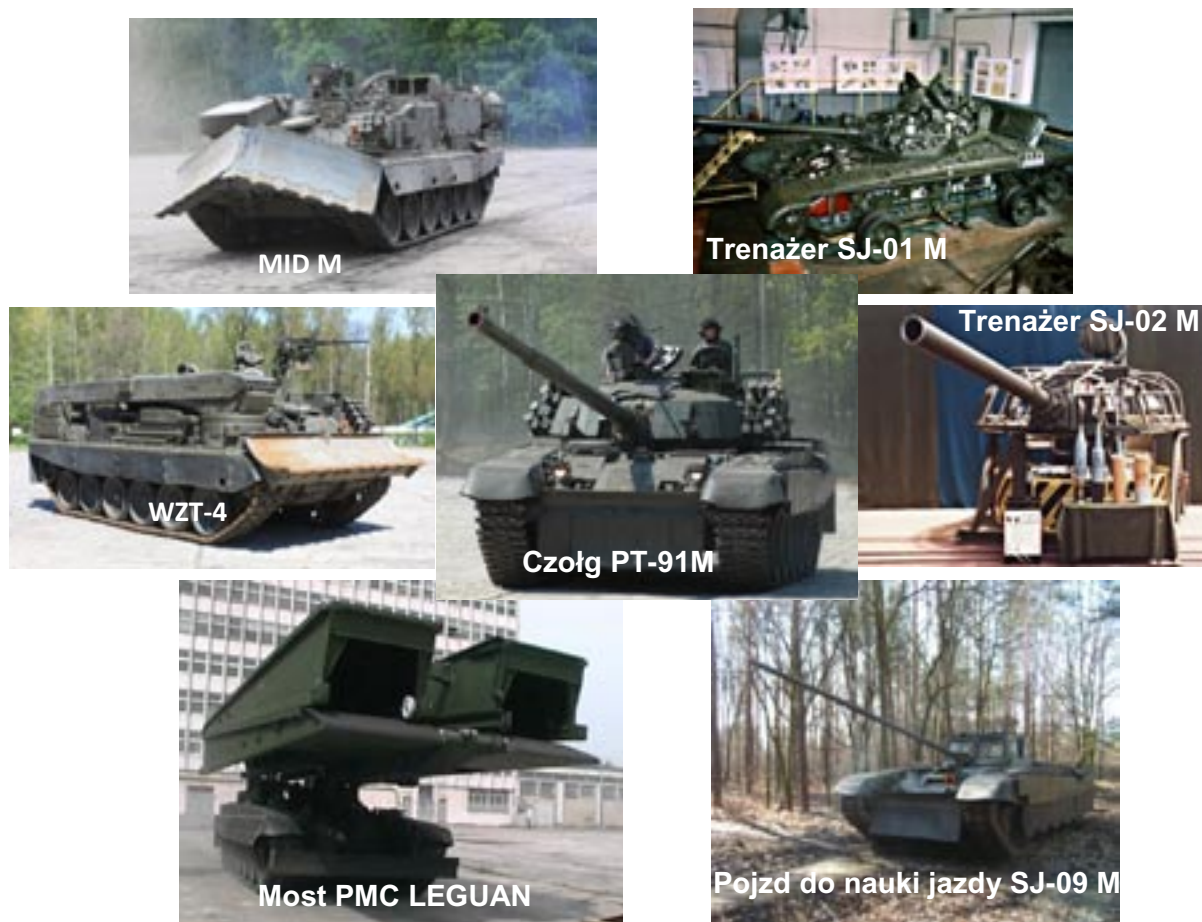
Rys. 16. Sprzęt inżynierski wykonany w OBRUM sp. z o.o. na bazie MBT PT-91M
