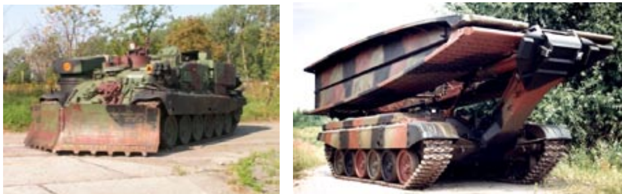
a) b) Rys. 14. Bazowe pojazdy inżynieryjne – program FET a) Czołg inżynieryjny MID; b) Most szturmowy PMC-90
